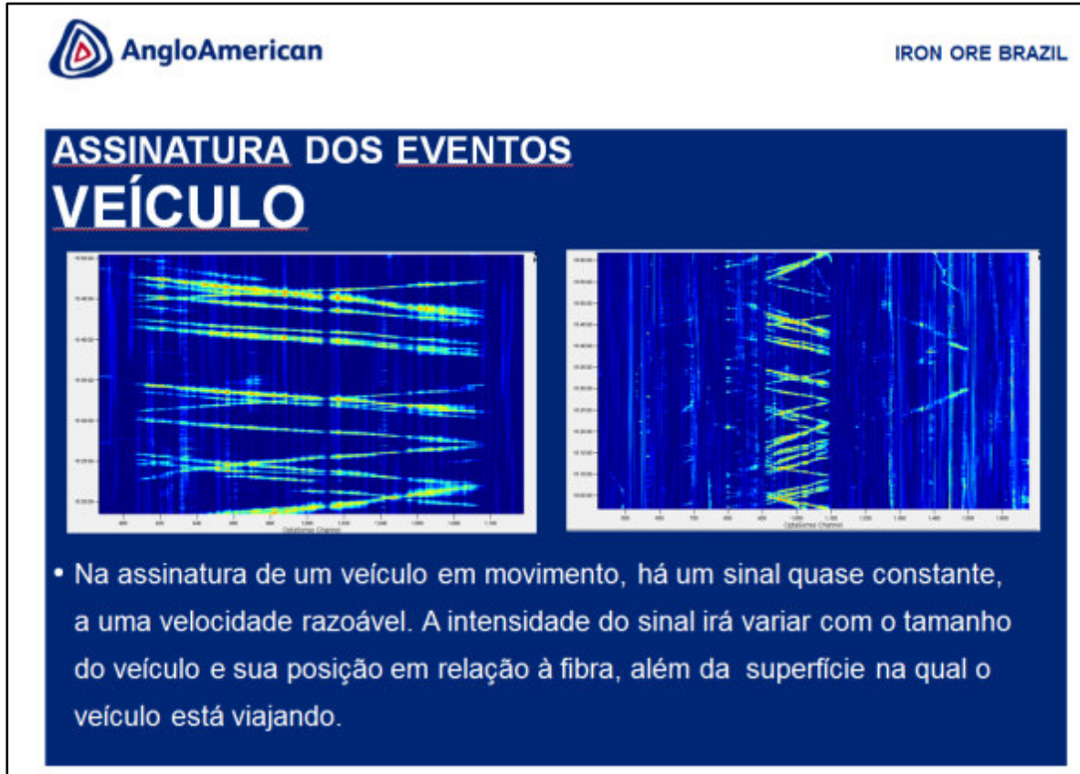
Figura 3.4.1 – Assinatura do sinal capturada pelo sistema Optasense a partir da passagem de veículo.
