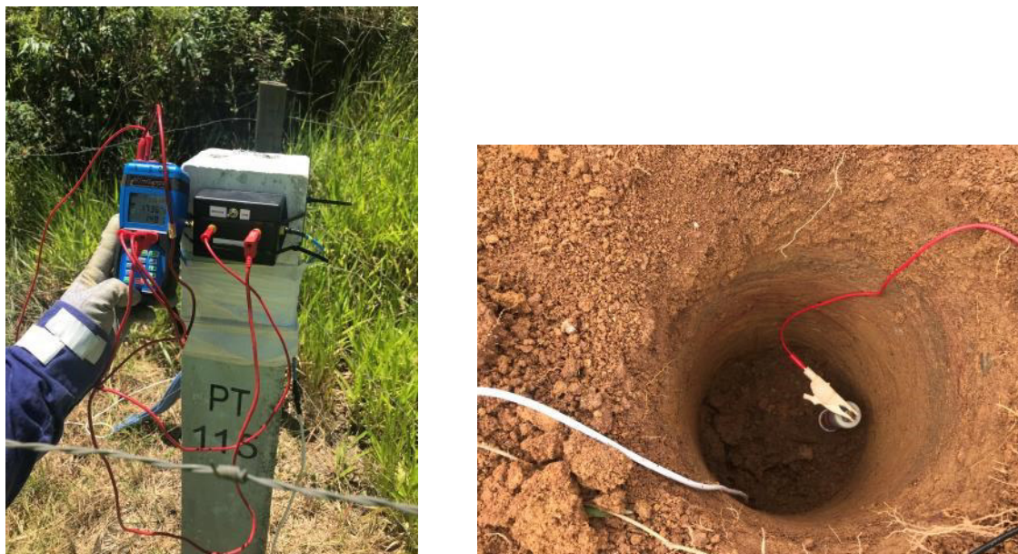
Figura 3.1.44 – Ilustração da medidas de potenciais ON-OFF em um PTE.
