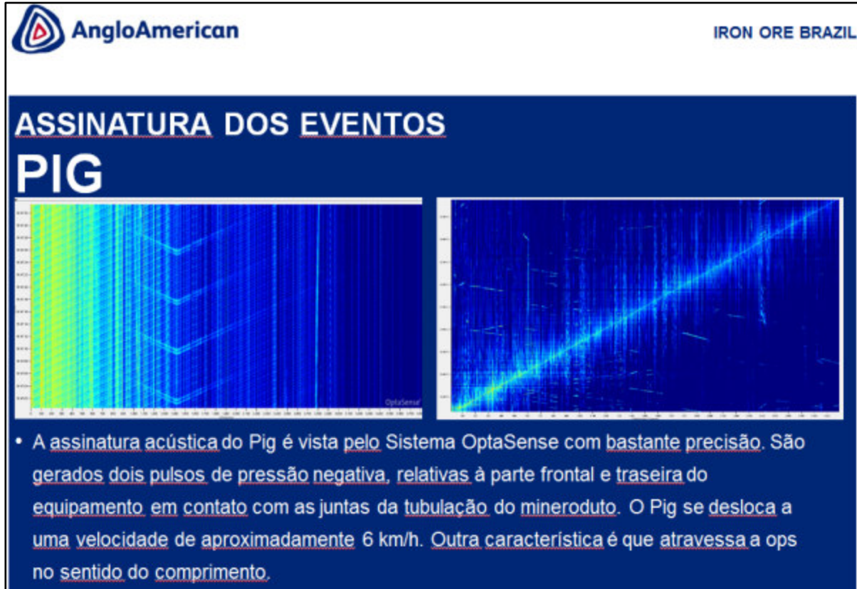
Figura 3.4.3 - Assinatura do sinal capturada pelo sistema Optasense a partir da passagem de PIG.
