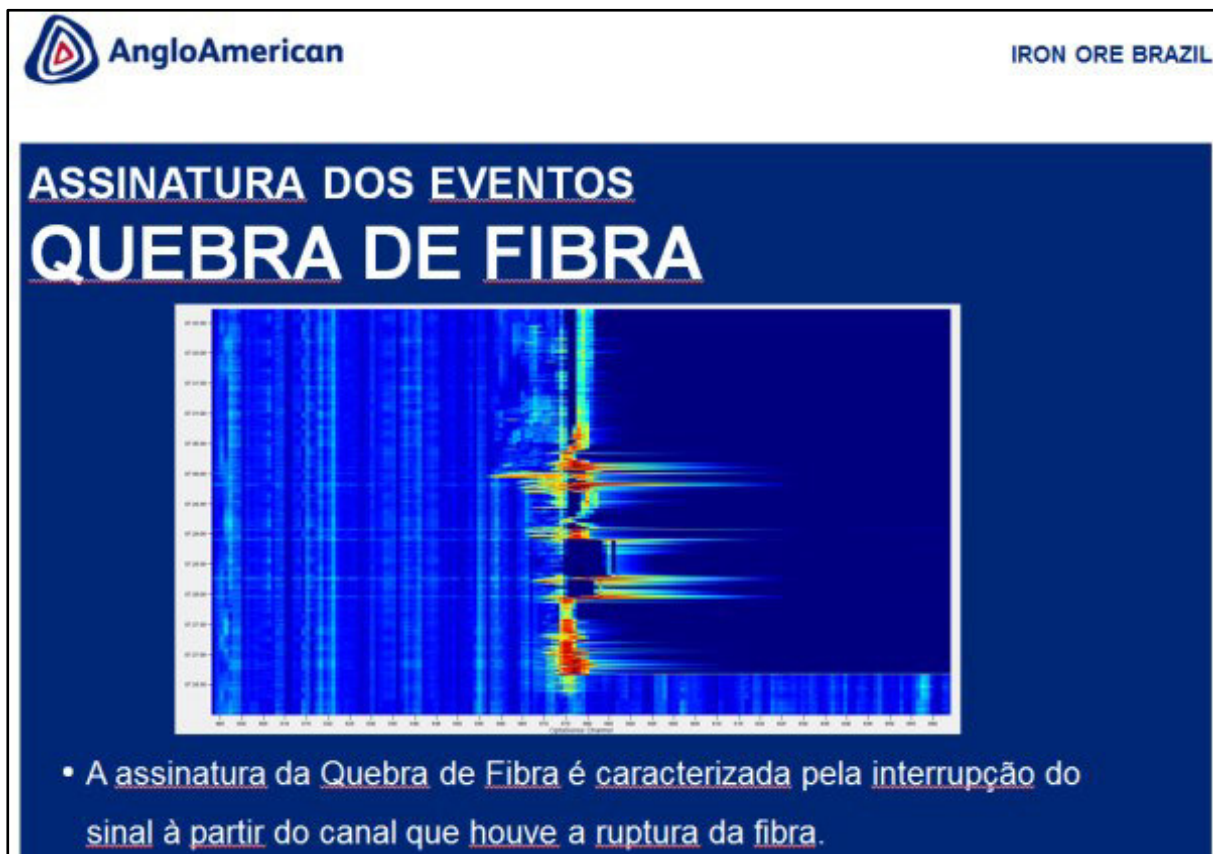
Figura 3.4.4 - Assinatura do sinal capturada pelo sistema Optasense a partir de simulações de quebra da fibra óptica.
