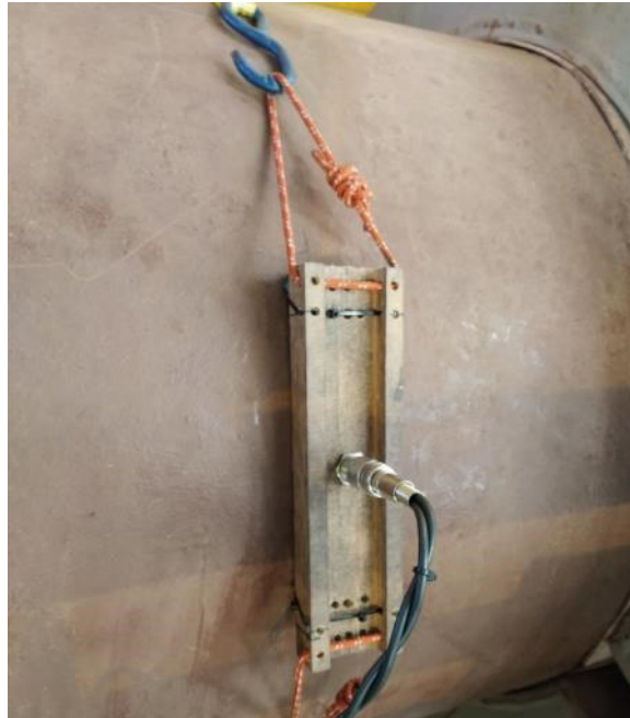
Figura 3.2.7 - Acima, o sensor magnético indutivo e abaixo, os sensores magnéticos
